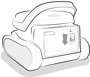
2. Filterzugangsklappe durch Anheben des Riegels öffnen.
